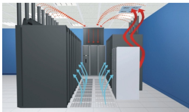
Εικόνα 1. Παραδοσιακός τρόπος εγκατάστασης Datacenter (με ψευδοπάτωμα)
